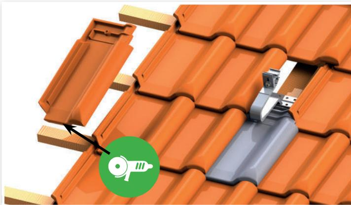
Richten Sie die Dachhaken mit Hilfe einer Schnur in horizontaler Richtung aus und befestigen Sie diese mit 2 Tellerkopfschrauben in den Sparren. Achten Sie dabei, dass in jeder Lochreihe eine Schraube sitzen muss.
