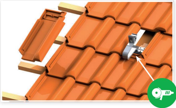
Optional kann der Ziegel, der unter dem Dachhaken liegt, durch einen Blechziegel ersetzt werden. Entfernen Sie die Lippe des darüberliegenden Dachziegels mit einem Winkelschleifer (Diamantblatt).
