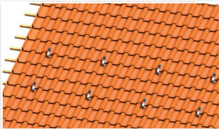
Bei Aufsparrendämmungen muss der Dachhaken mit 2 „Holzschrauben mit Fixiergewinde“ in den Sparren befestigt werden. Die Holzschrauben müssen mind. 60 mm in den Sparren verankert sein.
