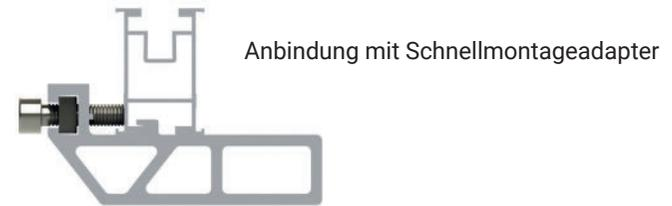
! Bitte beachten: Achten Sie darauf, dass die Trägerprofile gerade und spannungsfrei montiert werden. Anzugsdrehmoment der Fixierschrauben: M8 15 Nm / M10 30 Nm.
